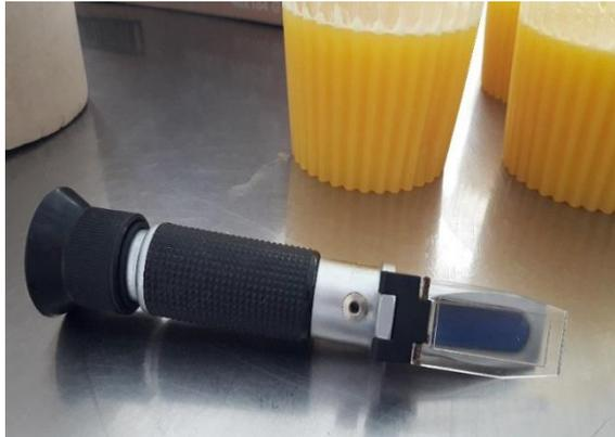
**Anexo 7.** Refractómetro para medición de grados Brix
