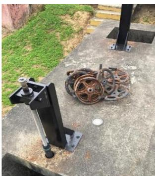
**Fotografía 39** Partes de las válvulas en estado corroído y amontonadas
