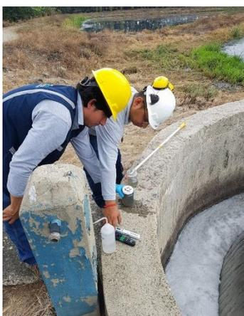
**Fotografía 26** Ensayo en sitio, pH y temperatura en diferentes puntos de la PTAR.
