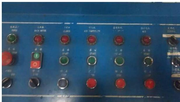
Figura 3. 5. Tablero de control unidad single facer
