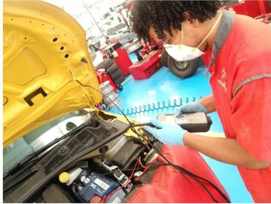
Figura 46: Revisión estado de batería
