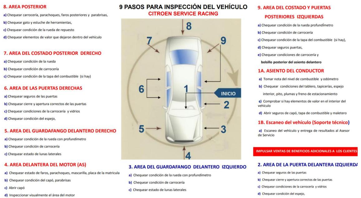
Figura 31: 9 Pasos para inspección inicial del vehículo. Se toma como referencia información proporcionada por fábrica.
