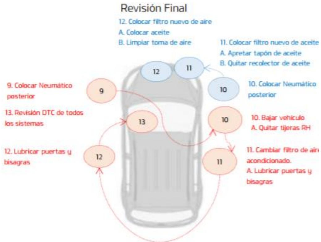
Figura 34: Revisión final de la unidad. Se toma como referencia información proporcionada por fábrica e información levantada de la medición de tiempos.
