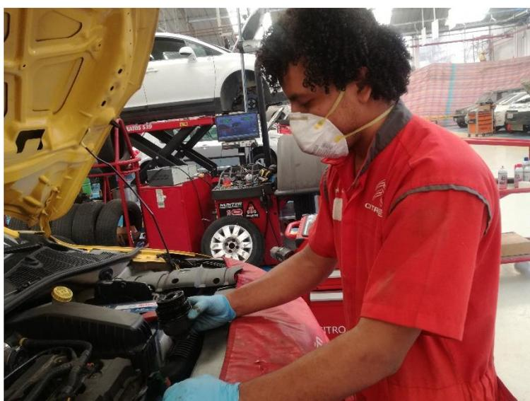
*Figura 50: Sustitución de filtro de aceite*
