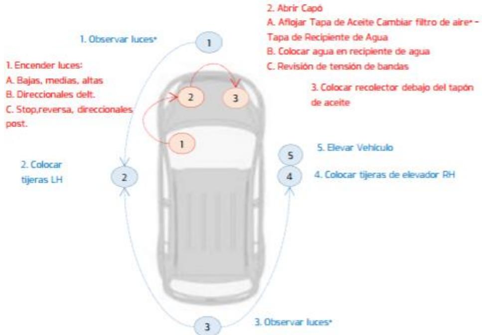
Figura 32 Inspección de Luces y Elevación de vehículo. Se toma como referencia información proporcionada por fábrica e información levantada de la medición de tiempos.
