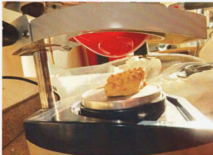
Fig. 68: Estado de calentamiento del EVA ideal para comenzar con el proceso de succión al vacío.
