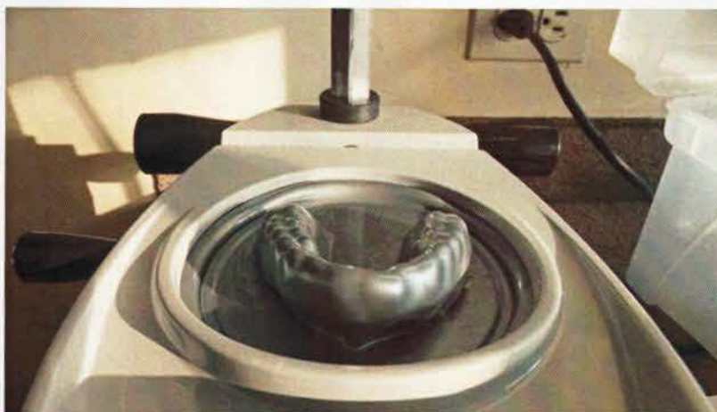
Fig. 45: Primera lámina del Protector Bucal Personalizado lista, esperamos que se enfríe durante 6:00 min según indicaciones del fabricante
