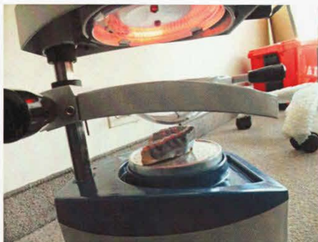
Fig. 46: Fusión entre la primera lámina de EVA y la segunda
