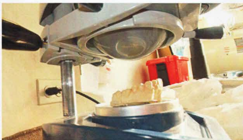
Fig. 44: Estado de calentamiento del EVA ideal para comenzar con el proceso de succión al vacío. Fuente: Heydi Morales Campoverde Guayaquil – Ecuador
