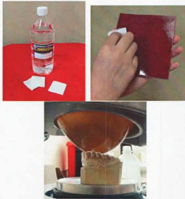
Fig. 27: Proceso de fusión de las láminas EVA Fuente: Heydi Morales Campoverde Guayaquil – Ecuador
