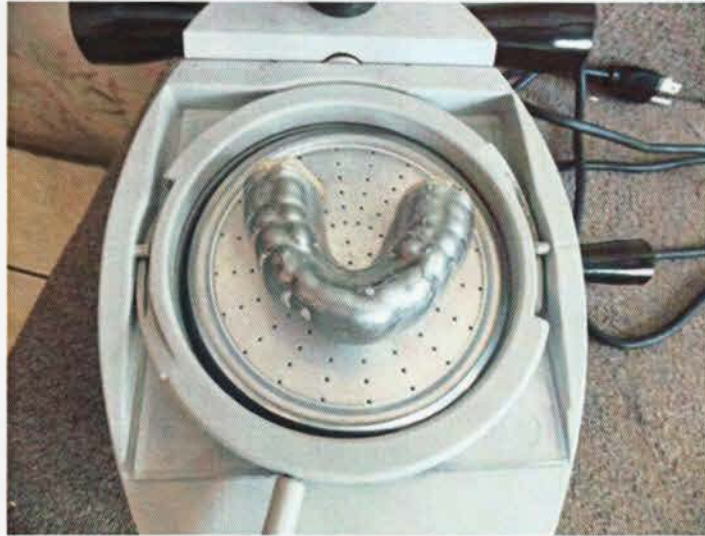
Fig. 47: Segunda lámina del Protector Bucal Personalizado lista, esperamos que se enfríe durante 6:00 min según indicaciones del fabricante
