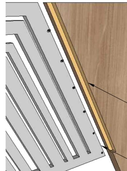
Entalladura para colocación de faldón metálico
