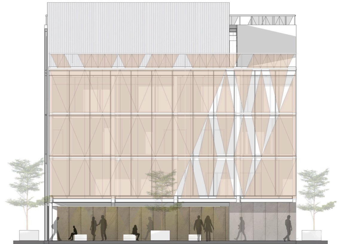
Sistema de paneles en fachada abierto. Reducción de la plaza en caso de no existir actividades programadas en la noche o para controlar el ingreso de personas por una sola calle, según sea la necesidad. 130 m2 de plaza hacia la calle Montúfar.
