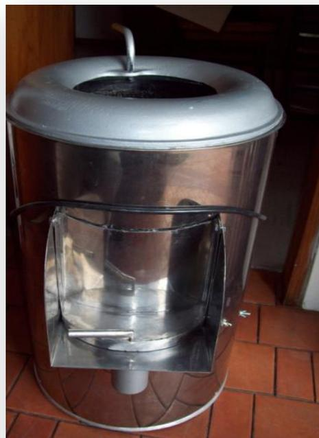
Fabricada en acero inoxidable, sobre base en fundiciones de aluminio, superficies de pelado en piedra natural en disco y pared, Superficies de pelado en grafito, sistema de eje corto dispuestos en rodamientos auto lubricados, bandas americanas 23" Tapa en aluminio fundido, motor brasilero WEG 110-220 voltios, de 1/2 hp. Swich de encendido de dos posiciones. Tubo de alimentación de agua en cobre dispuesto en la tapa, compuerta de salida en acero.
