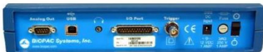
Figura 3. 7: Parte trasera del Biopac MP36.
