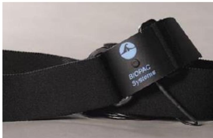
Figura 3. 4: Sensor para registrar la respiración del Biopac MP36.
