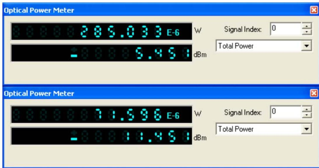
Figura 1. Mediciones de la potencia óptica de las señales en los extremos del enlace.
