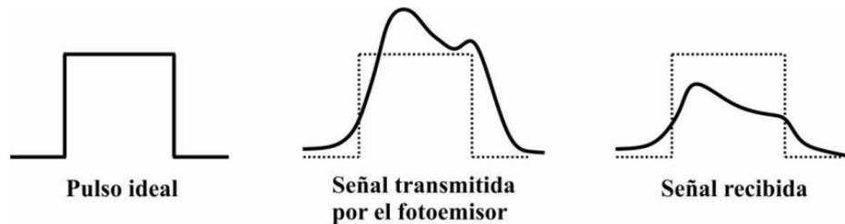
Figura 2. 8: Evolución de un pulso óptico.
