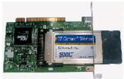
**Figura 1.9 Tarjetas PCMCIA con adaptador PCI: 13 dBm**
