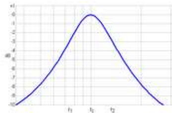
Fig.5 Grafica de la Respuesta frecuencial de un filtro pasa banda
