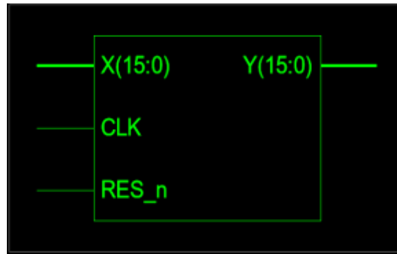
Fig. 4. Entidad de un filtro Fir en FPGA XILINX
