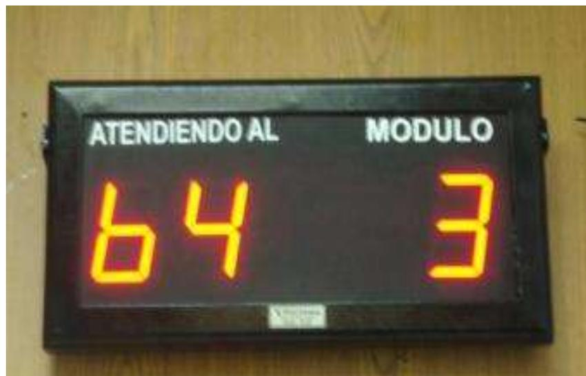
**Fig. 5-17 El modulo de visualización para llamado de turnos**
